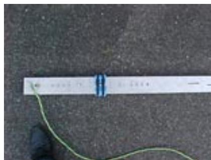
**13 cm RX-Antenne mit Kanalfilter**
